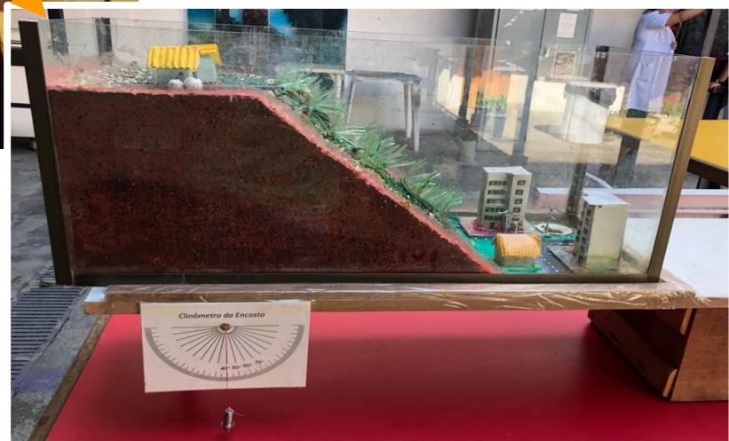
Figura 2 - Maquete de simulação de deslizamentos - acionamento do macaco hidráulico para aumentar a declividade da encosta e provocar o deslizamento, representações de ocupações no topo e na base da encosta e medidor da declividade.
